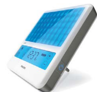
Das goLITE BLU erzeugt Licht mit der Wellenlänge und Helligkeit, die sich als Regulator der zirkadianen und Alarmierungszyklen erwiesen hat. Größe = (14 x 14 cm)
